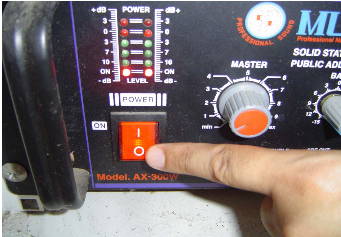
ภาพที่ 3.1.1 การเปิด-ปิด เครื่องขยายเสียง ปุ่ม VOLUME MASTER ต้องอยู่ระดับต่ำสุดเสมอ
